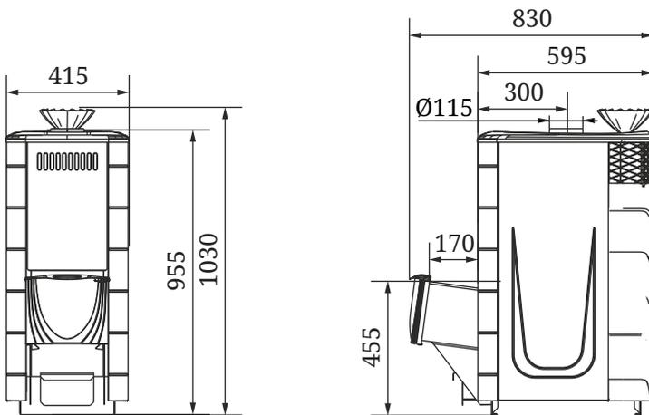
Рисунок 5. Габаритно-монтажные размеры печи «Гейзер XXL 2017»
