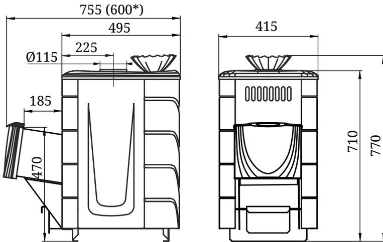
Рисунок 1. Габаритно-монтажные размеры печи «Гейзер Мини 2016»
