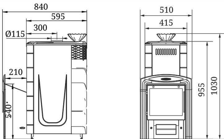
**Рисунок 6. Габаритно-монтажные размеры печи «Гейзер XXL 2017 Витра»**
