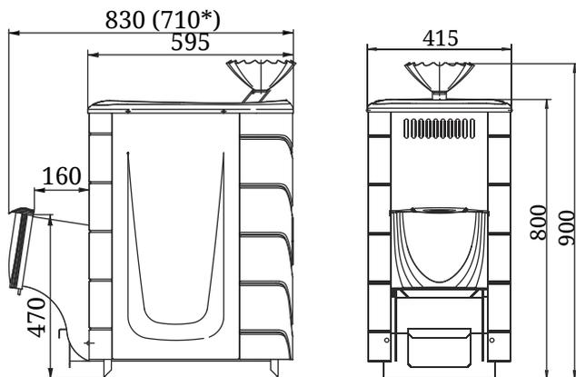
**Рисунок 3. Габаритно-монтажные размеры печи «Гейзер 2014», «Гейзер Супер»**
